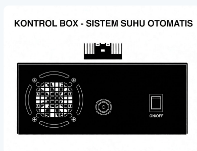
Gambar 5.1 — Panel Belakang Kontrol Box · Kipas Exhaust · Jack Audio · Tombol ON/OFF Utama
